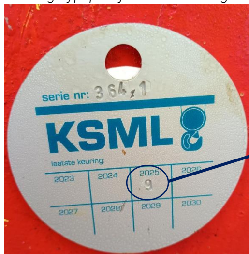
Figuur 1: keuringstypeplaatje met korte uitleg
